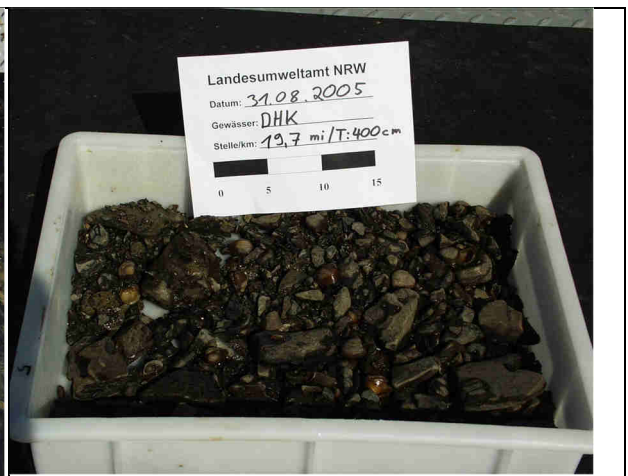
Abb. 8.4-6: RHK-Mittellage. Substrat Kies: Lage etwa 2-3 cm, Muscheln ( Corbicula ) regelmäßig verteilt.
