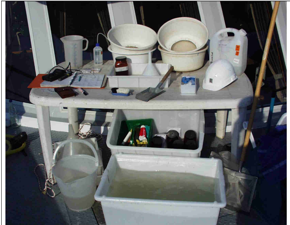
Abb. 8.4-14 Erforderliches Material für die quantitative Probenahme von Makrozoobenthos von Bord eines Schiffs
