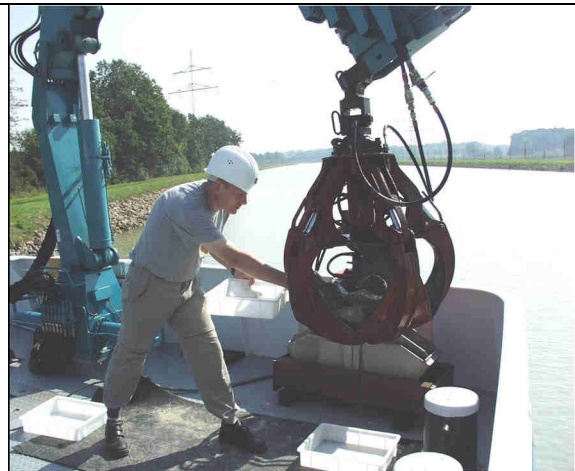
Abb. 8. 4-4 Entnahme einer Unterprobe von etwa 1/8 m 2 und Überführung in eine Weißschale
