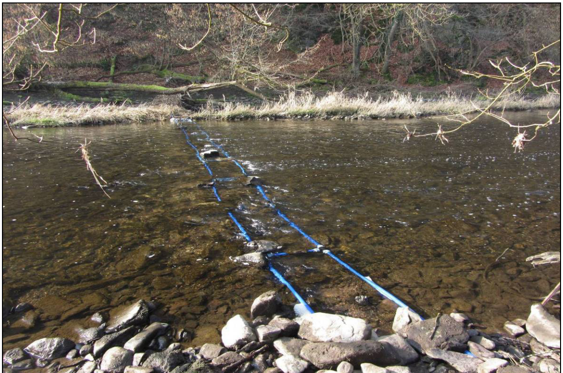
Abb. 28: Auf dem Gewässergrund des Mutterbettes am Auer Kotten fixierte „schwimm drüber“-Antenne Nr. 10
