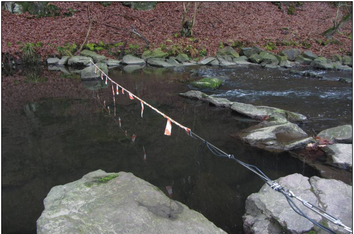
Abb. 27: Als Seilantenne konstruierte „schwimm durch“-Antenne Nr. 14 am Ausstieg des Raugerinnes am Ausleitungswehr
